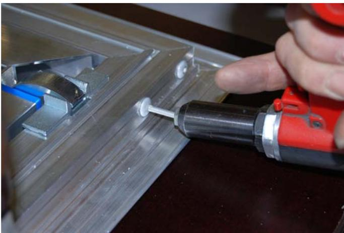
Eckverbindung mit Monobolts montieren.
