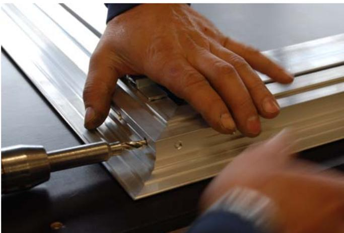
Löcher durch Eckverbindung bohren.
