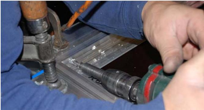
Löcher durch Eckverbindung bohren
