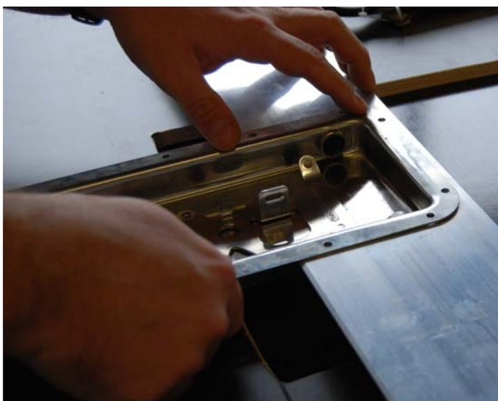
Positionierung Verschluss im Türprofil.
