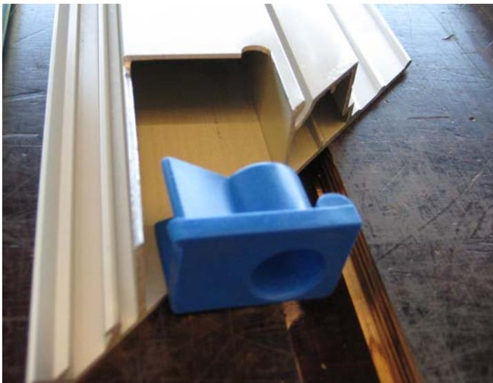
Montage Lagerbuchse (2x) im Türprofil.
